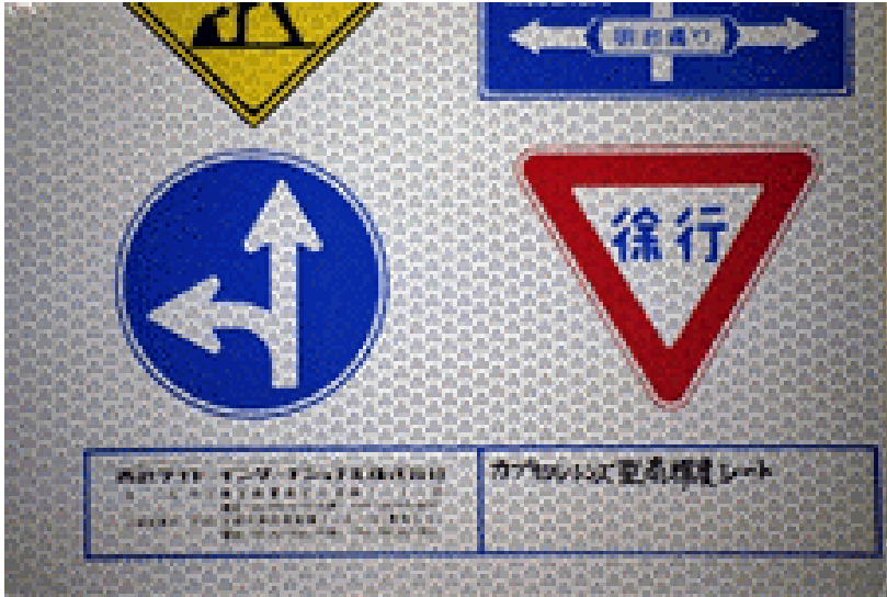
写真1. 当社インキで印刷された標識 : 素材 反射シート インキ: 500N シリーズ
